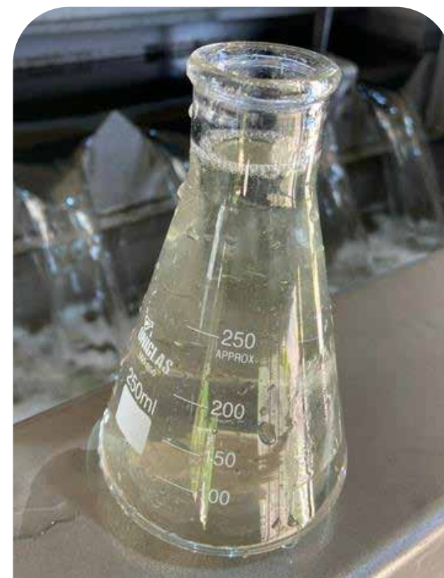
Efluente final após o flotador
